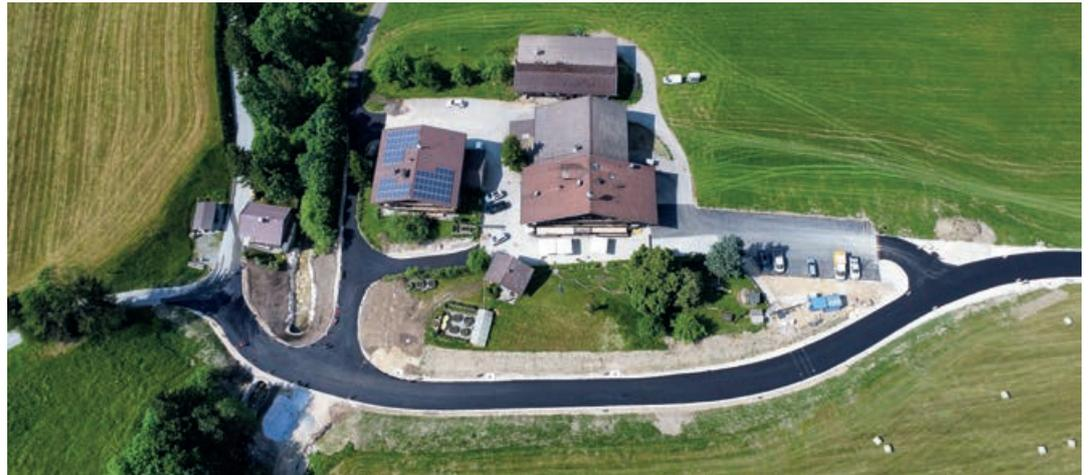
Im Bild ist deutlich erkennbar, dass die Straße auf Grund des bestehenden Geländes im Einschnitt geführt wird. Beidseitig neben den Banketten werden Sickermulden zur Straßenentwässerung ausgebildet (Fotonachweis: Harald Ganster).
