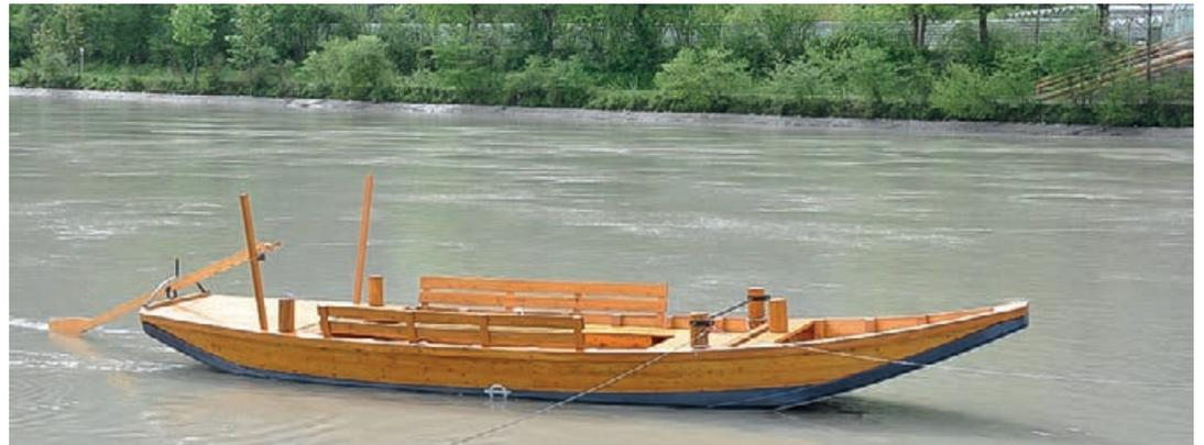
Bis zu zwölf Passagiere haben auf dem zehn Meter langen und knapp drei Meter breiten Schiff aus Lärchenholz Platz. Die Fähre ist ab sofort bis Mitte Oktober bei Schönwetter täglich von 10 bis 17 Uhr in Betrieb. Eine Überfahrt kostet zwei Euro. Der Fährmann stellt das Boot dazu in einen passenden Winkel zur Strömung des Flusses. Bei zu niedriger Fließgeschwindigkeit unterstützt ihn ein Elektroantrieb.
